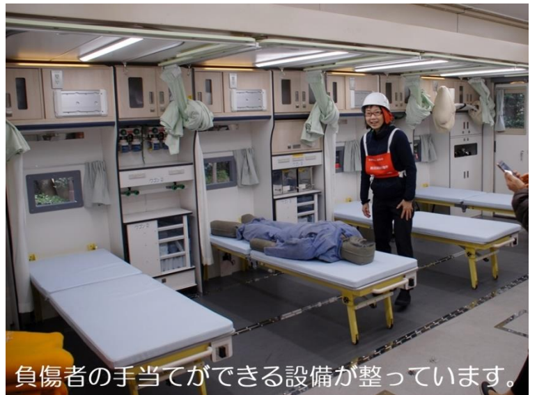
日本に4台しかない「特殊救急車」 両側を広げて救護所になります。
